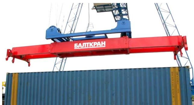
Рисунок 2. Спредер для застройки крупнотоннажных контейнеров.
